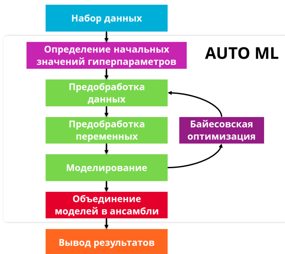
Рисунок 157 Принцип работы узла "AutoML"
