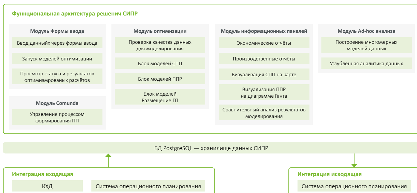
Рисунок № 1. Функциональная архитектура решения СИПР
